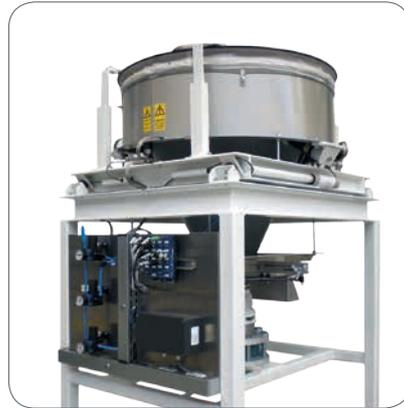
Ausführung mit Quetschverschluss für freien Auslaufquerschnitt.
